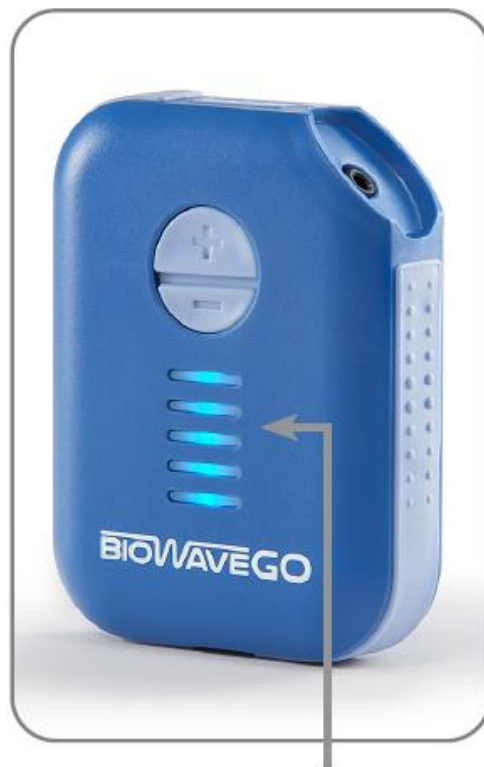
A jel intenzitását mutató LED oszlopdiagramos kijelző
